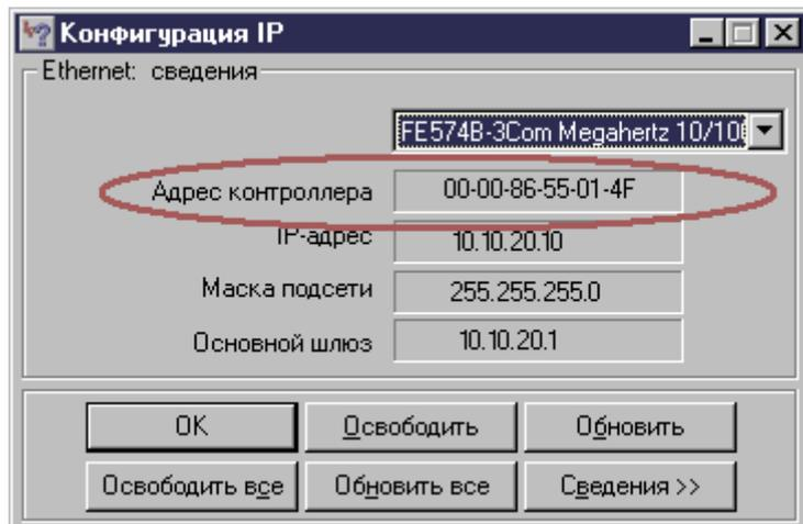
5. В строке «IP-адрес» записан логический (IP) адрес сетевого адаптера Вашей рабочей станции.
